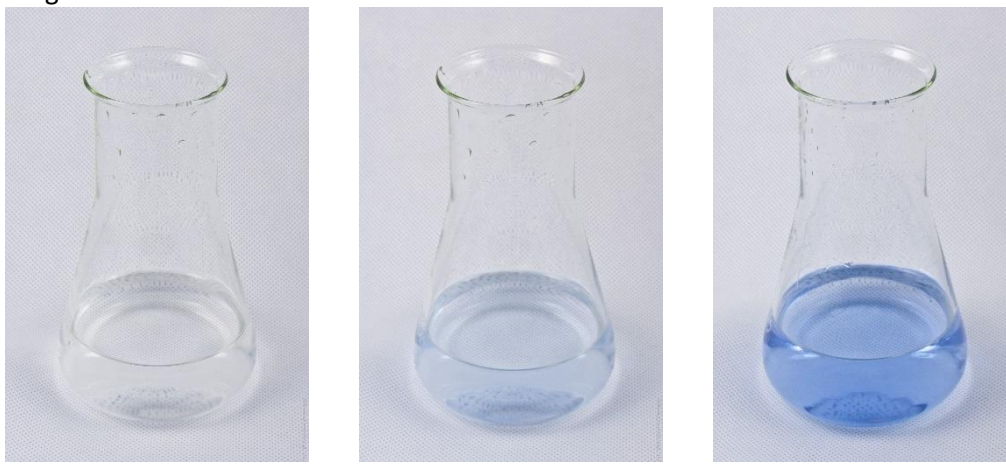
Oznaczenie H_3PO_4 jako kwasu dwuprotowego wobec tymoloftaleiny: a) próbka przed miareczkowaniem, b) PK miareczkowania, c) próbka przemiareczkowana. Fot. dr W. Wrzeszcz.
